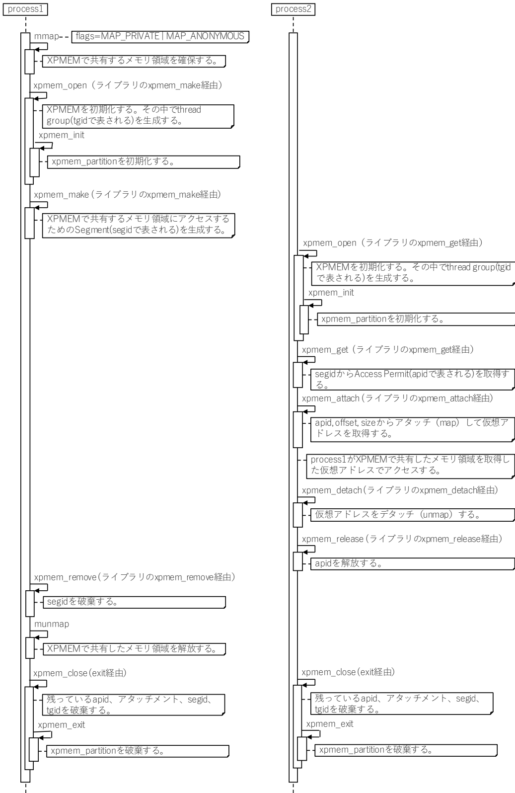
Figure 2.10: XPMEM の動作フロー
