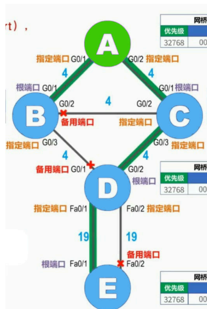
图5 最终形成的链路拓扑（绿色粗线为连通的链路）
