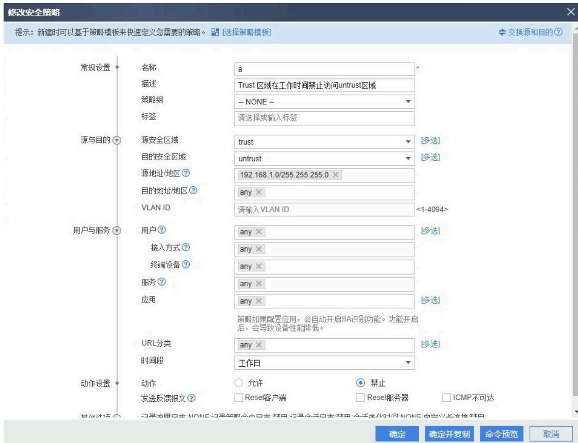
Figure 18: 配置 trust 区域在工作时间禁止访问 untrust 区域
