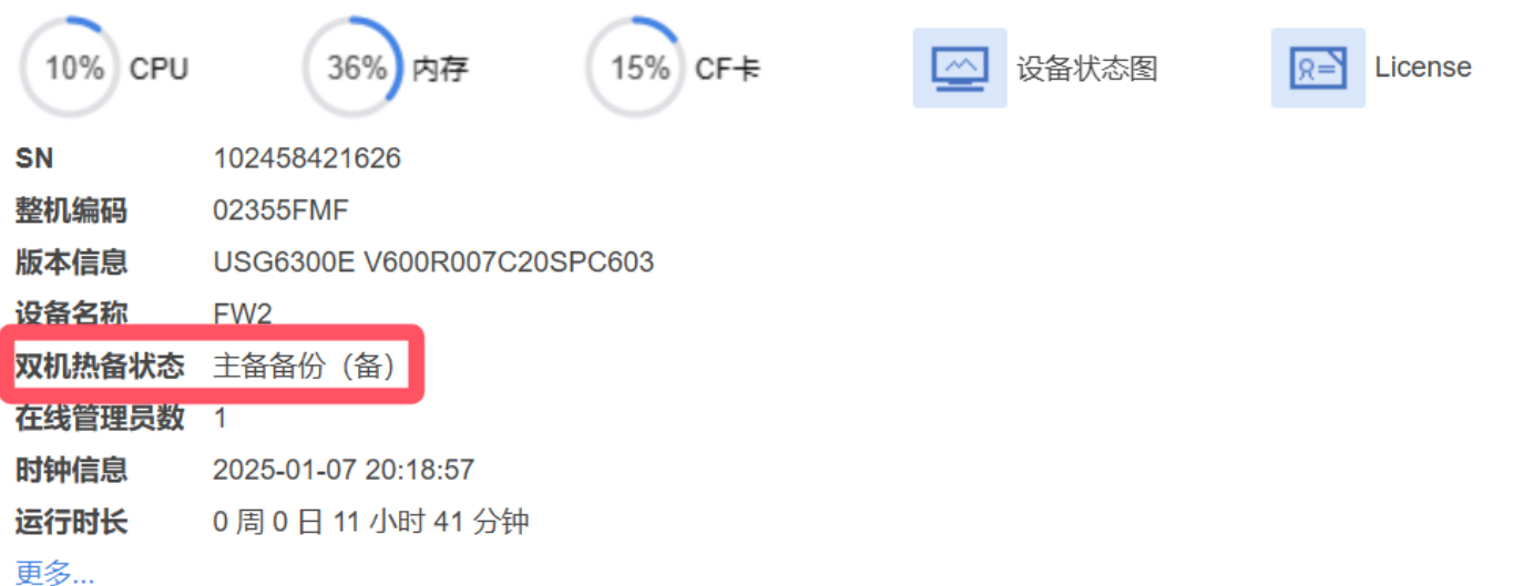
Figure 7: 防火墙双机热备（备，FW2）
