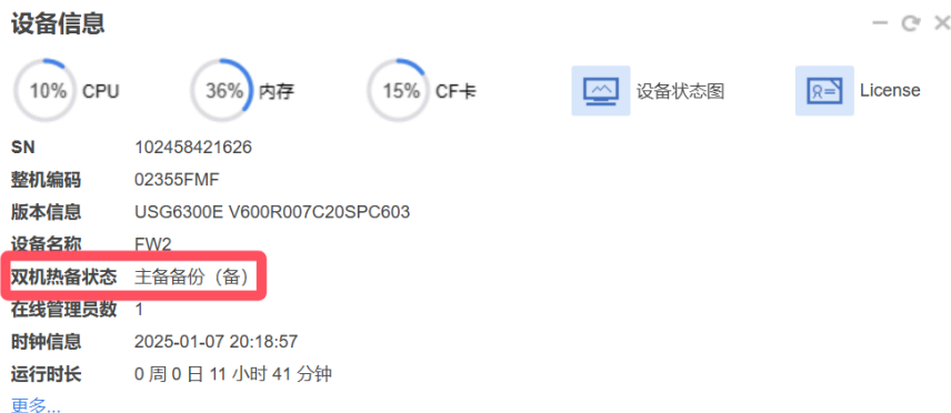
Figure 7: 防火墙双机热备（备，FW2）
