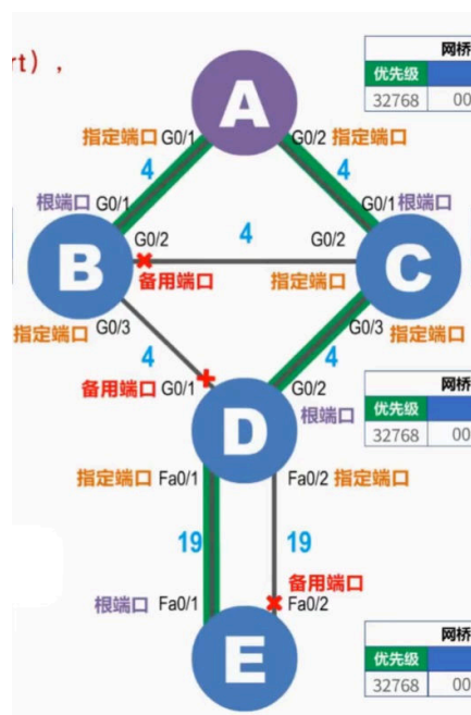
Figure 5: 最终形成的链路拓扑（绿色粗线为连通的链路）
