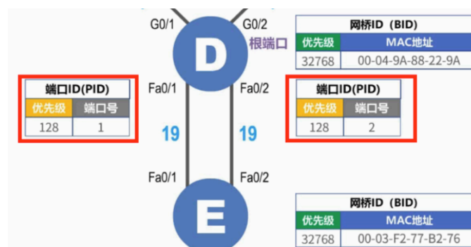
Figure 4: 对端 PID 最小
