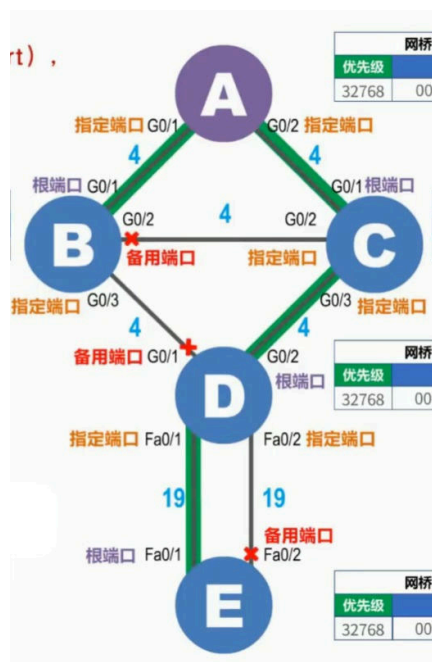
Figure 5: 最终形成的链路拓扑（绿色粗线为连通的链路）
